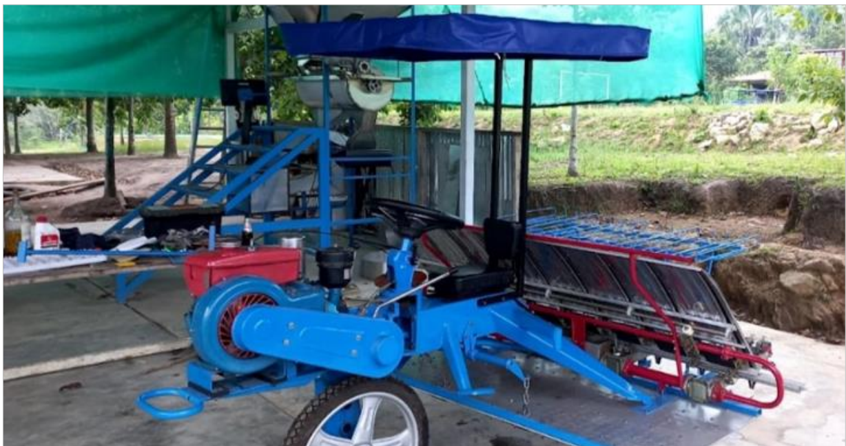
Figura 2. Prototipo de plantadora de arroz construido
